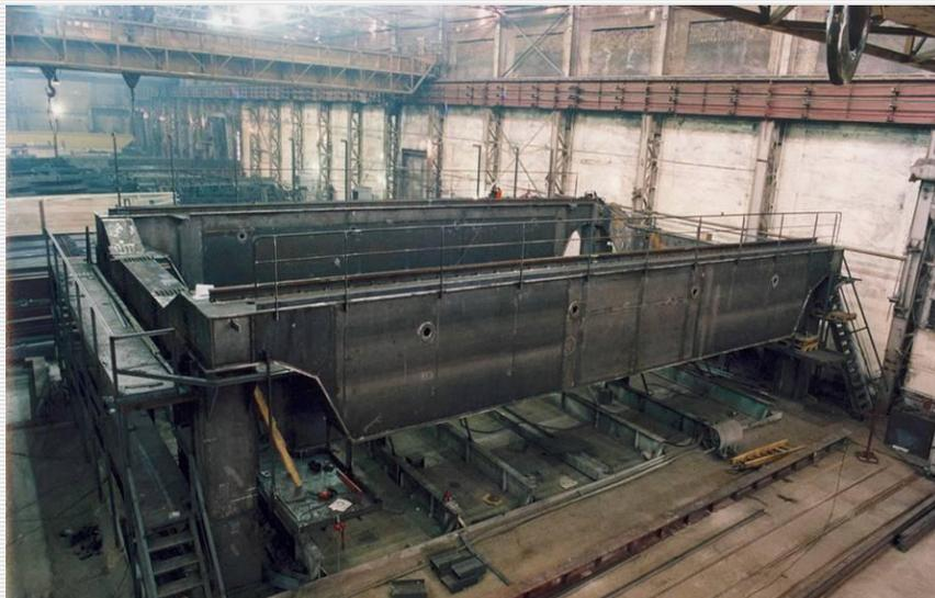
Литейный кран для ОАО "Магнитогорского металлургического комбината" грузоподъемностью 300/125 тнс, пролетом 20 м – „Konecranes“
