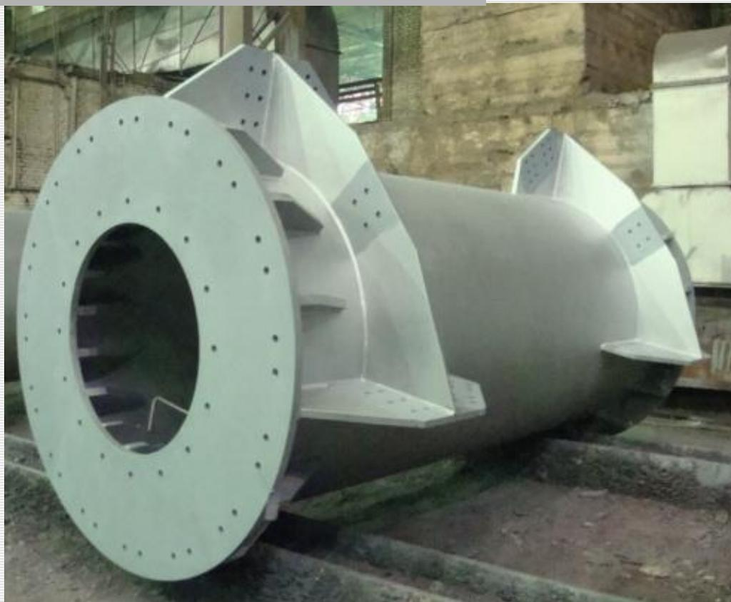
Сборные сталебетонные секции тел металлических опор для строительства железнодорожного подъездного пути, который соединит станцию Улак Байкало-Амурской магистрали с Эльгинским угольным месторождением (Якутия) (разработка Филиала ОАО ЦНИИС "Научно-исследовательский центр "Мосты")
