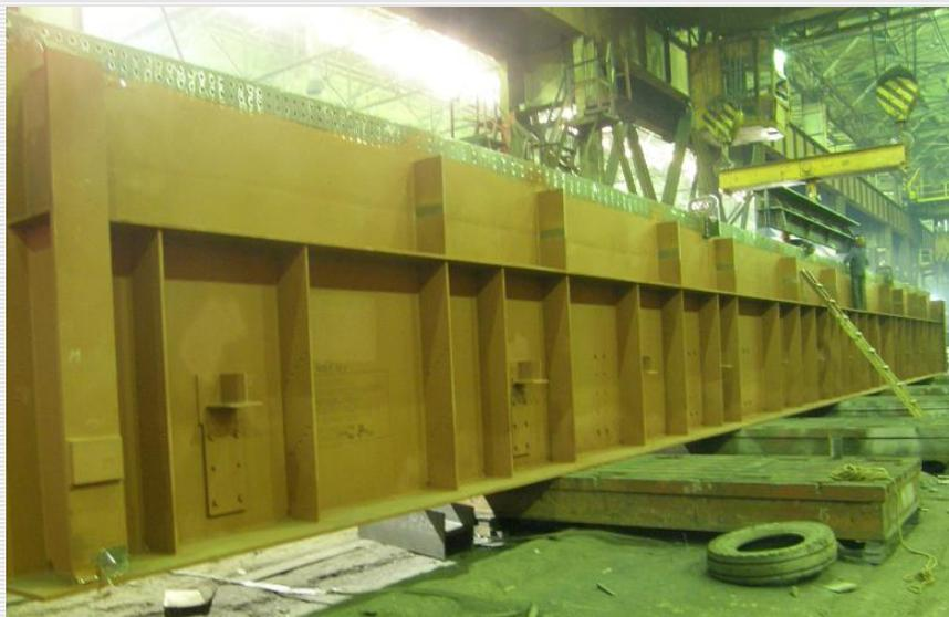
Хребтовые балки высотой 6м. и длиной 33 м.
