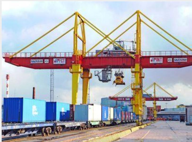
Козловой контейнерный кран производства «Балткран» грузоподъемностью 45 тонн для ОАО «РЖД»
