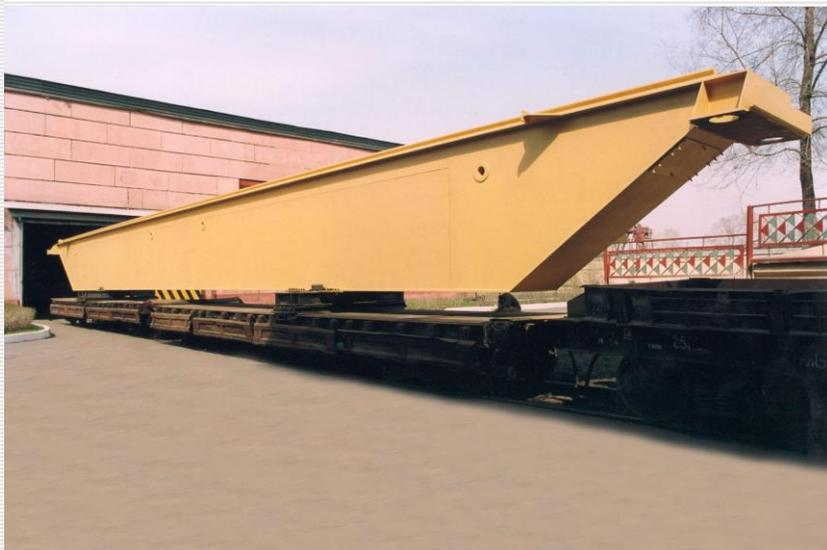
Мостовой электрический слябовый кран грузоподъемностью 85тнс, пролетом 34,5м
