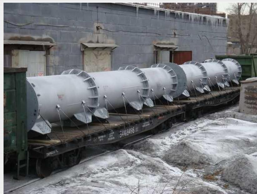
Сборные сталебетонные секции тел металлических опор для строительства железнодорожного подъездного пути, который соединит станцию Улак Байкало-Амурской магистрали с Эльгинским угольным месторождением (Якутия) (разработка\_Филиала ОАО ЦНИИС "Научно-исследовательский центр "Мосты")
