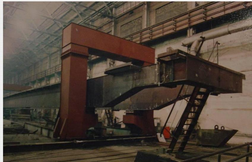
Козловой кран для ОАО "Бурья-Кран" грузоподъемностью 12,5 тнс, пролетом 50 м
